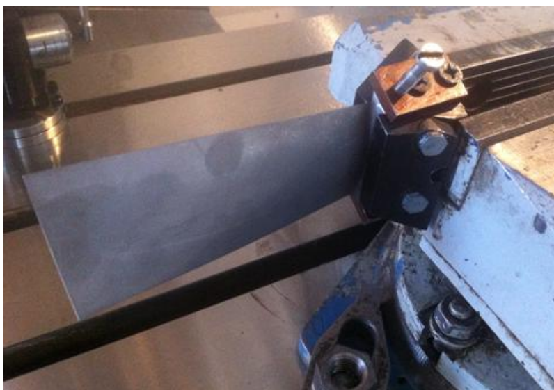
Рисунок 2 - Лопатка компрессора низкого давления, закреплённая в технологической оснастке
