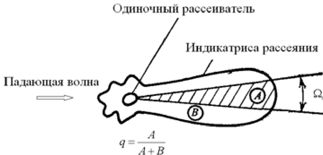
Рис. 8. Вычисление параметра q [15]; \Omega_r - ширина диаграммы направленности фотоприемника
