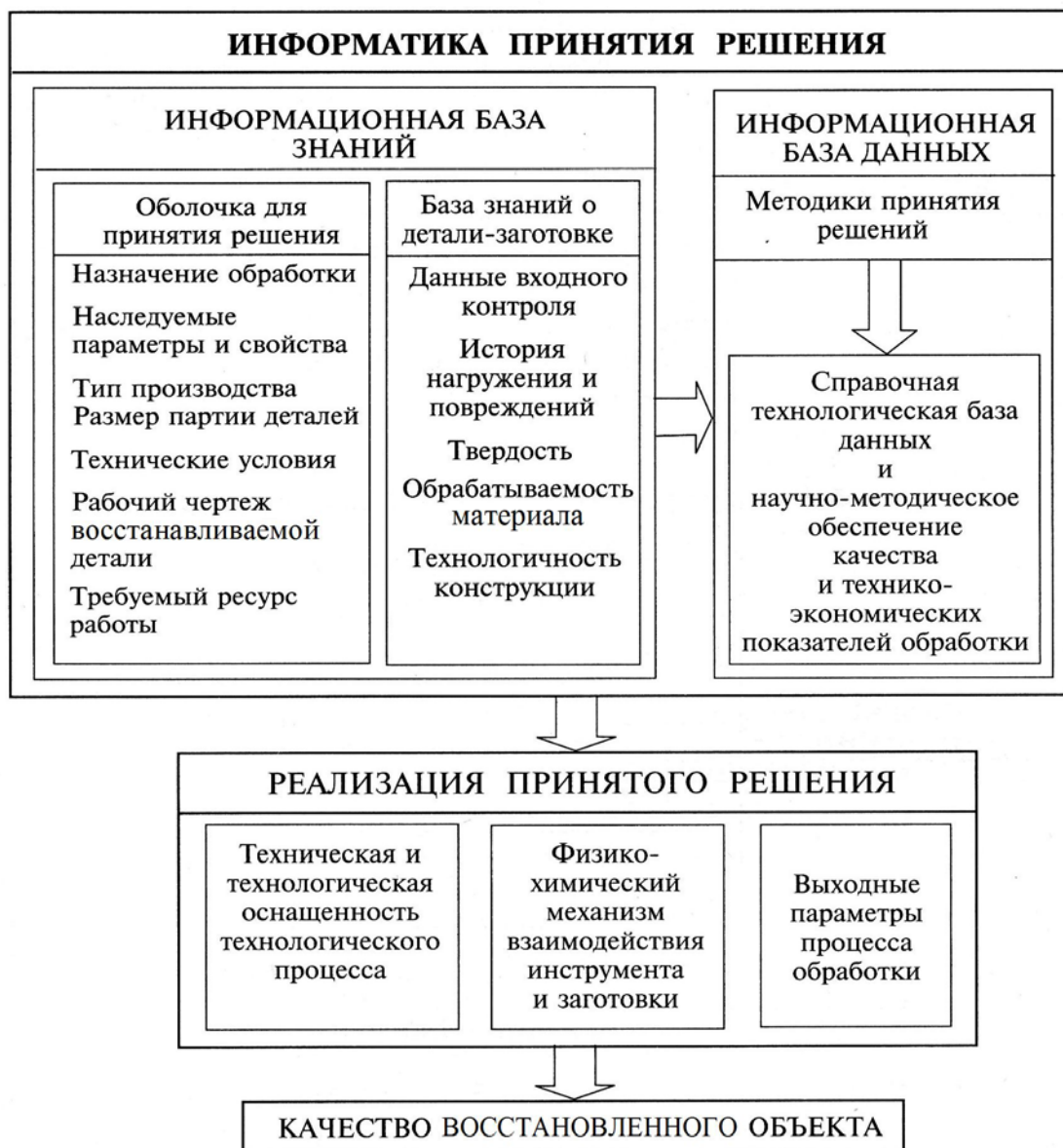
Рис. 2. Структурно-логическая модель обеспечения качества восстанавливаемого объекта
