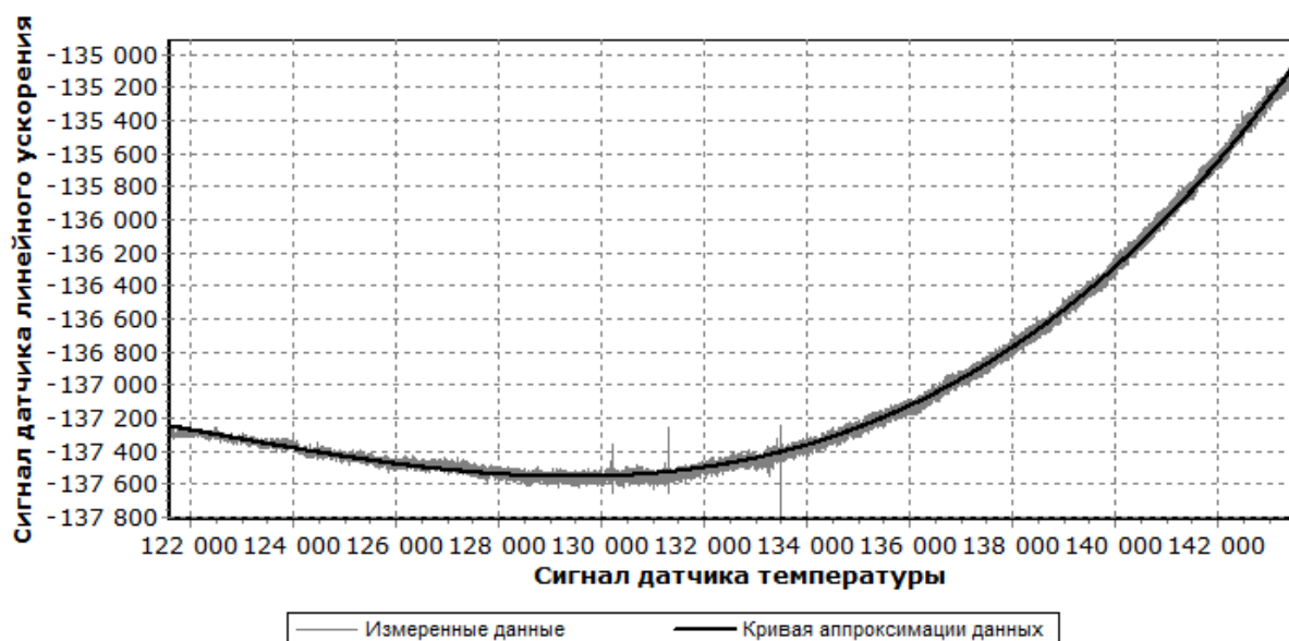
Рис 4. Аппроксимация третьим порядком температурной зависимости сигнала микромеханического датчика линейного ускорения ADXL210 фирмы Analog Devices при его разогреве от -40\text{ }^{\circ}\text{C} до +60\text{ }^{\circ}\text{C} .
