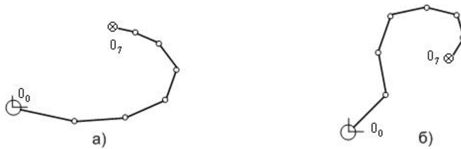
Рис. 2. Оптимальная конфигурация манипулятора: двумерный случай; препятствия отсутствуют
