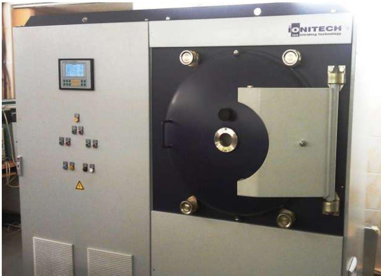
**Рис. 1.** Ионно-плазменная установка для азотирования ИОН-25И, производства IONITECH (Болгария)
