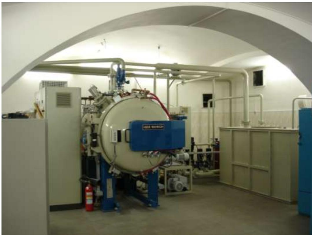
**Рис. 2.** Вакуумная установка 10.0VPT-4020/24N, производства SECO/WARWICK Group (Польша): общий вид
