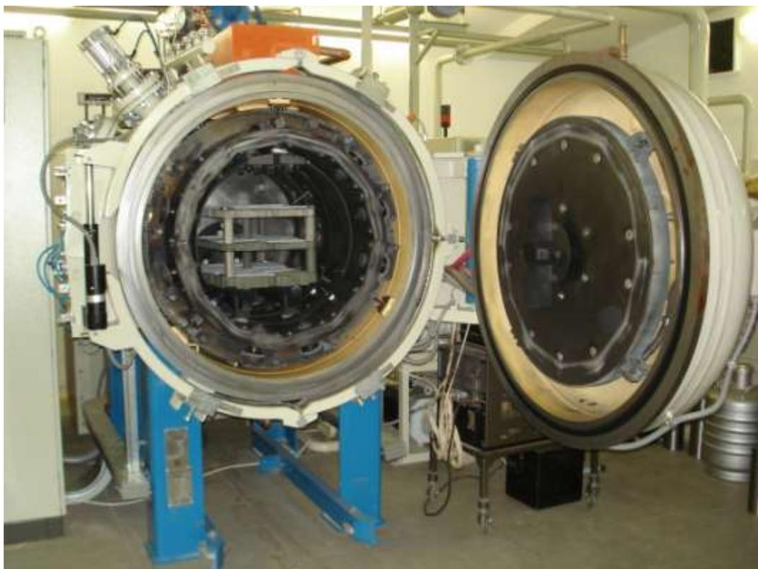
**Рис. 3.** Вакуумная установка 10.0VPT-4020/24N, производства SECO/WARWICK Group (Польша): загрузка рабочей камеры
