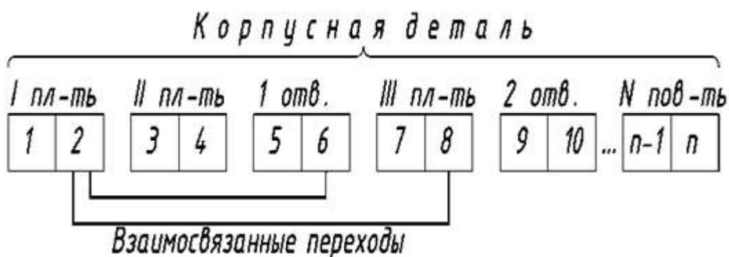
Рис. 3. Схема нумерации переходов
