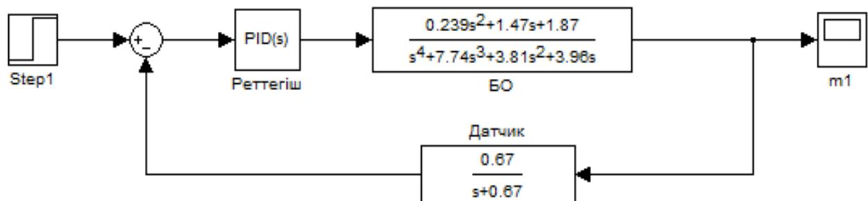
Рис. 9. Структура САУ с ПИД-регулятором
