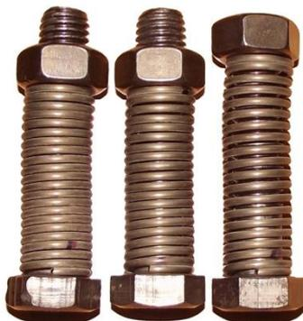
Рис. 1 Пружины исследования под сжатием
