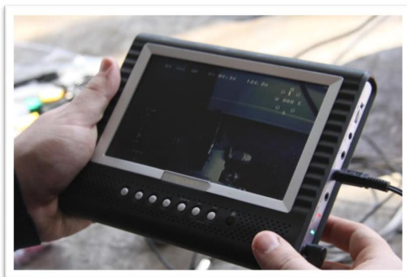
Рисунок 4 . Минимонитор блока управления подводным аппаратом «Акватор».
