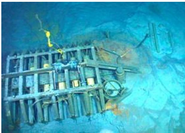
**Рисунок 8.** Коммутационный бокс обсерватории HUGO, подготовленный к подъёму со дна [11].
