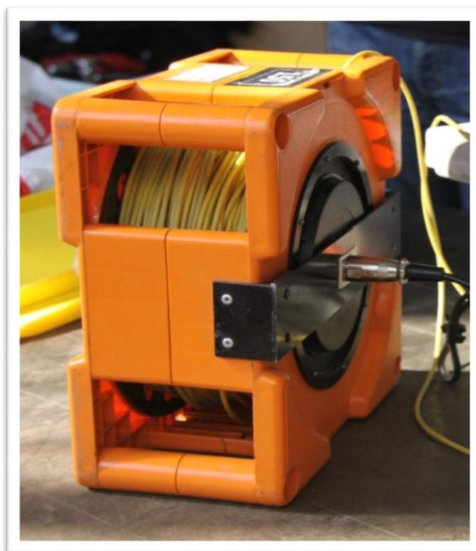
**Рисунок 5.** Вьюшка с кабелем однопроводной многожильной связи без дополнительных легких элементов плавучести на кабеле.
