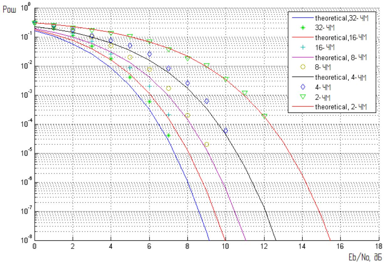
Рис. 3. Зависимость вероятности ошибки от отношения  $Eb/No$  при некогерентном приеме  $M$  ортогональных сигналов
