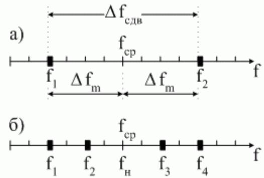
Рис. 1. Параметры частотно-манипулированных сигналов
