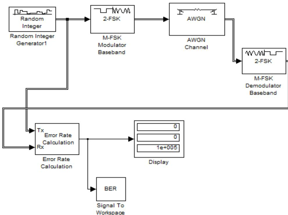
Рис. 2. Модель системы передачи информации для 2-FSK сигнала
