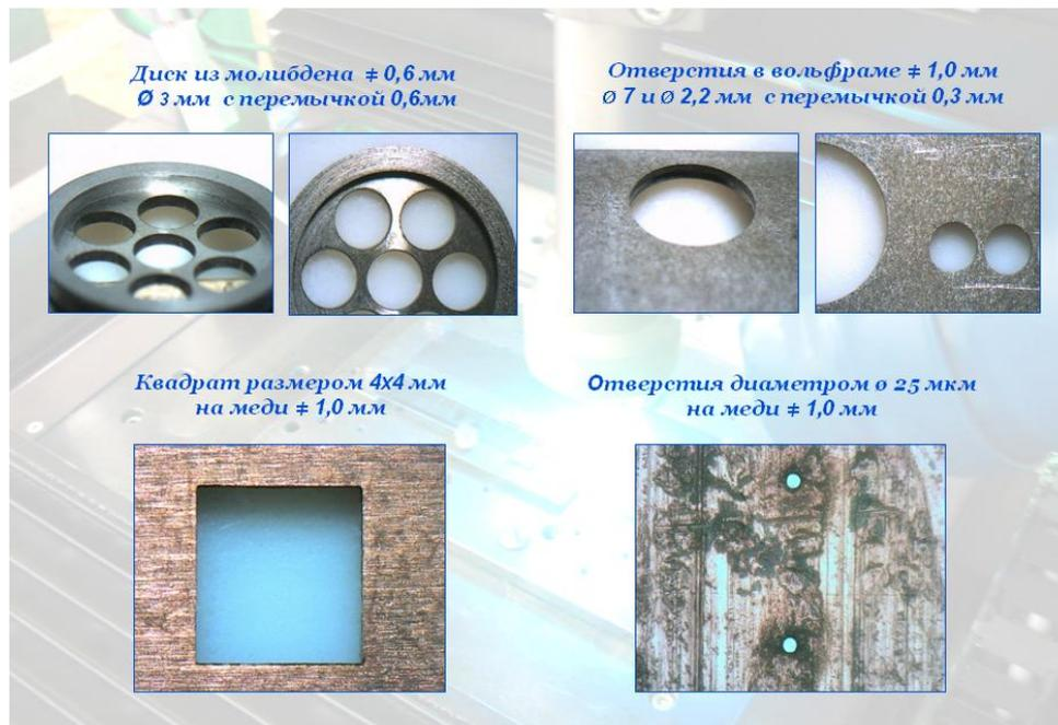
**Рис.17.** Примеры изображений фрагментов плоских деталей толщиной 0,6-1 мм, изготовленных на самой мощной АЛТУ «Каравелла-1М» ( $P_{\text{изл.}} = 20-25$  Вт)
