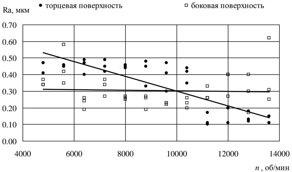
Рис. 9. Шероховатость обработанных поверхностей в зависимости от частоты вращения шпинделя, подача  $s_z = 0,08$  мм/зуб
