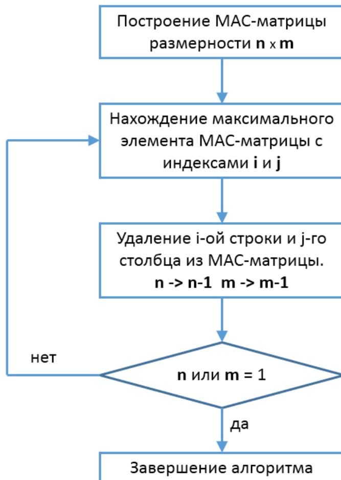
Рисунок 2 – Блок-схема алгоритма выбора соответствующих собственных форм колебаний
