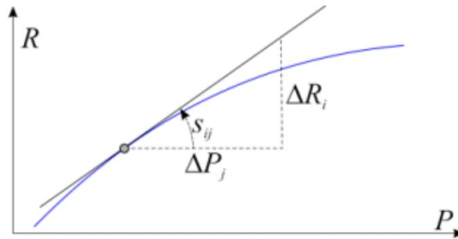
Рисунок 5 – Графическая интерпретация коэффициента чувствительности
