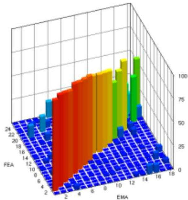
Рисунок 1 – MAC-матрица простой конструкции [9]
