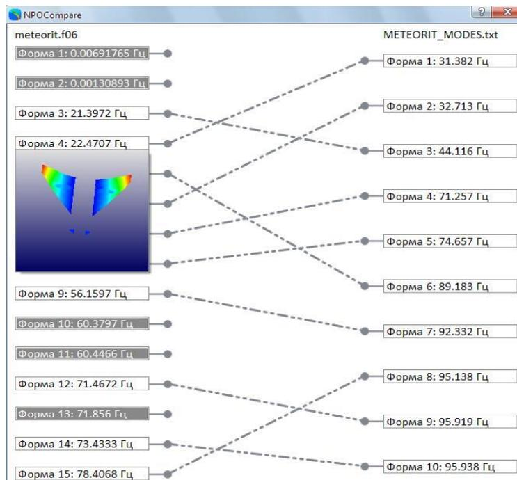
**Рисунок 4** – Визуализация работы алгоритма поиска соответствующих форм колебаний на примере конструкции макета крылатой ракеты “МЕТЕОРИТ”
