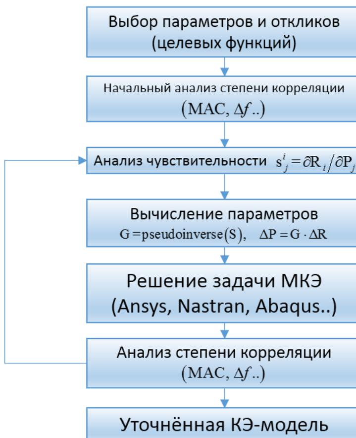
Рисунок 6 – Блок-схема алгоритма уточнения модели с помощью анализа чувствительности
