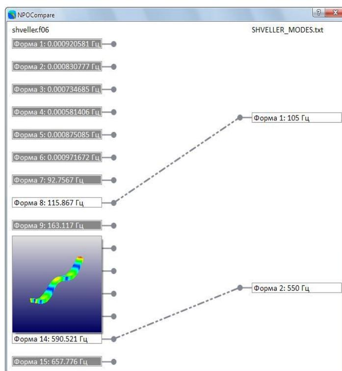
**Рисунок 3** – Визуализация работы алгоритма поиска соответствующих форм колебаний на примере простой конструкции
