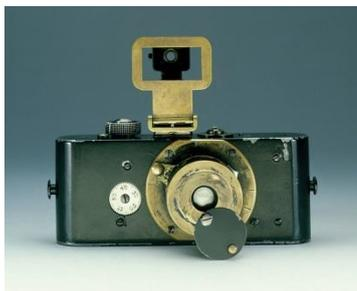
(нем. *Oskar Barnack*; 1879-1936) создал первый образец фотоаппарата Leica с малоформатным кадром. Серийное производство фотокамеры Leica-I началось с 1925 года. Размер фотокадра
