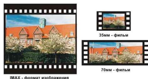
В аппаратах IMAX плёнка движется горизонтально, а не вертикально, как в большинстве остальных форматов. Размеры кадрового окна киносъёмочного аппарата IMAX составляют  $70,4 \times 52,6$  мм. IMAX не имеет совмещённой фонограммы на киноплёнке. Вместо неё изначально использовалась отдельная перфорированная магнитная лента шириной 35 мм, синхронизированная с кинопроектором. На ней записывался 7-канальный звук.
