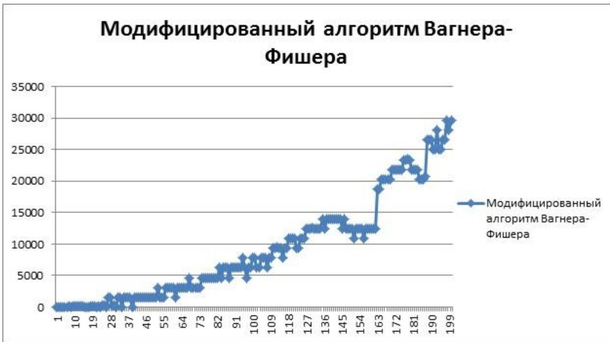
**Рисунок 4.** Зависимость времени выполнения (в тиках) алгоритма поиска расстояния Дамерау-Левенштейна от длины входного слова
