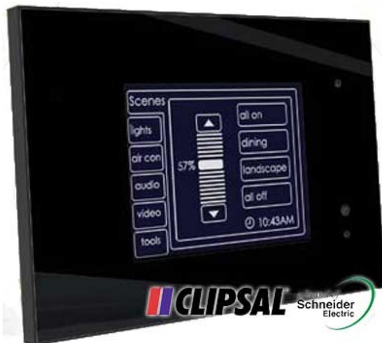
Рис. 1. Интеллектуальный термостат с графическим интерфейсом
