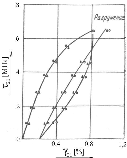
**Рис.13** Цикл при сдвиге
