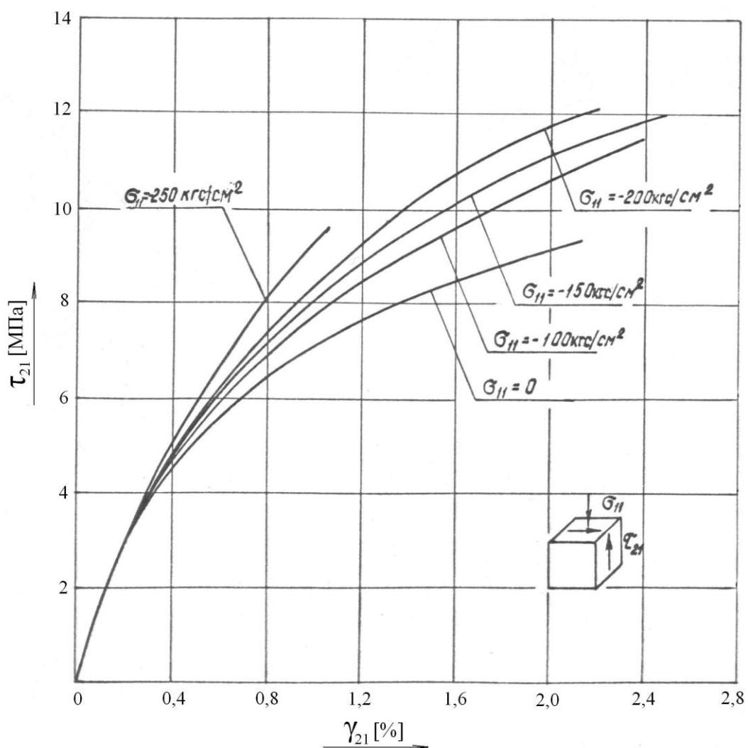
Рис.10 Испытания на сдвиг и на сдвиг с осевым сжатием
