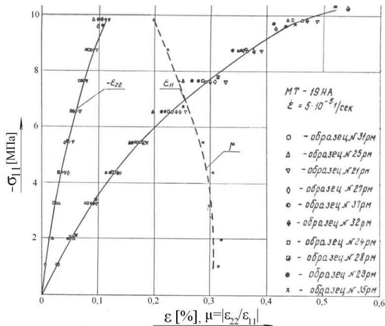
**Рис. 7** Кривые деформирования при испытании на растяжение
