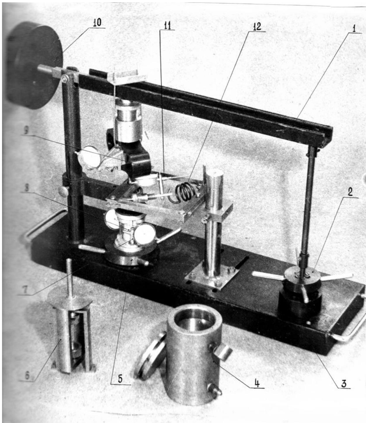
**Рис.9** Установка для комбинированного нагружения образцов (КНО). 1-рычаг; 2-винтовая пара для нагружения; 3-основание; 4-камера для создания внешнего давления; 5-гайка для фиксации образца; 6-реверса для испытания на растяжение; 7-механический тензометр для испытаний на сдвиг; 8-образец для испытаний; 9-динамометр; 10-противовес; 11-рамка для нагружения на сдвиг; 12-динамометр для измерения усилия сдвига.
