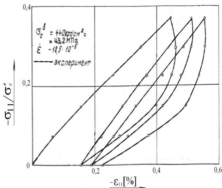
Рис.5 Цикл при сжатии
