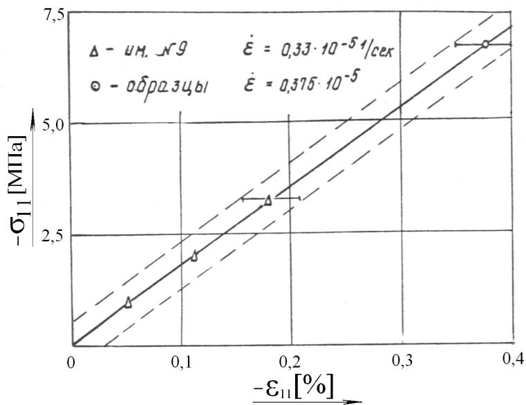
**Рис.14** Сравнение результатов испытания образцов и натурных изделий
