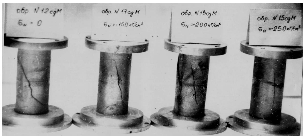
Рис.11 Разрушение образцов при сдвиге и при сдвиге с осевым сжатием
