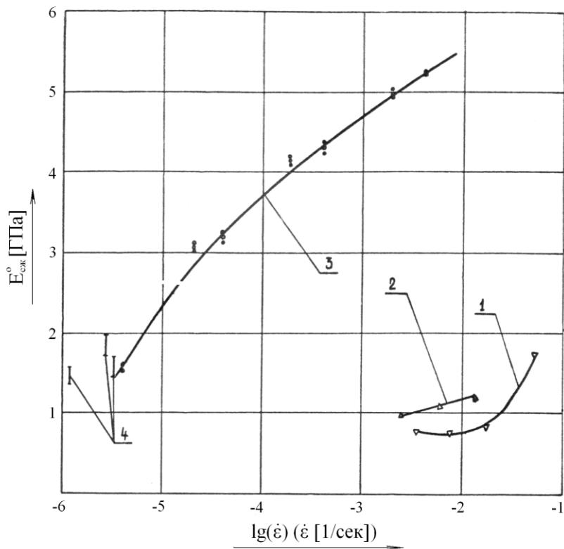
**Рис.15** Начальный модуль в зависимости от десятичного логарифма скорости деформирования. 1 - прессованные кубики с длинной ребра 20 мм; 2 - прессованные цилиндры высотой 30 мм и диаметром 20 мм; цилиндры изготовленные точением высотой 50 мм и диаметром 20 мм; 4 - натурные изделия.
