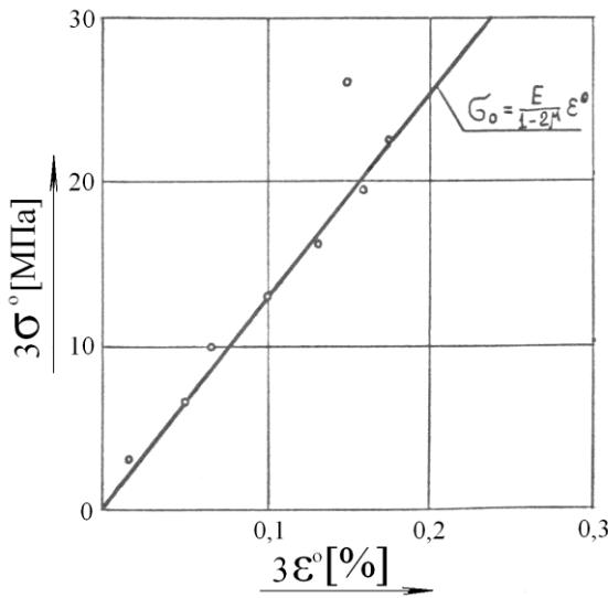
Рис.17 Зависимость между шаровыми тензорами напряжения и деформации
