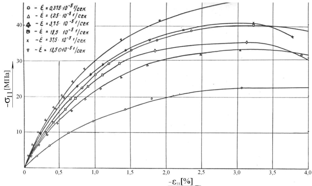
Рис.3 Зависимость от скорости деформирования при сжатии
