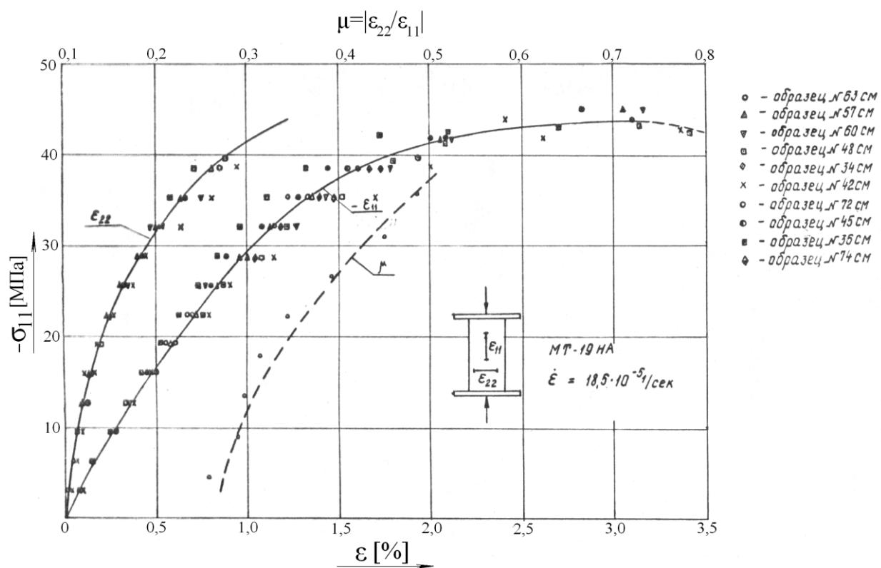
Рис.2 Кривые деформирования при сжатии
