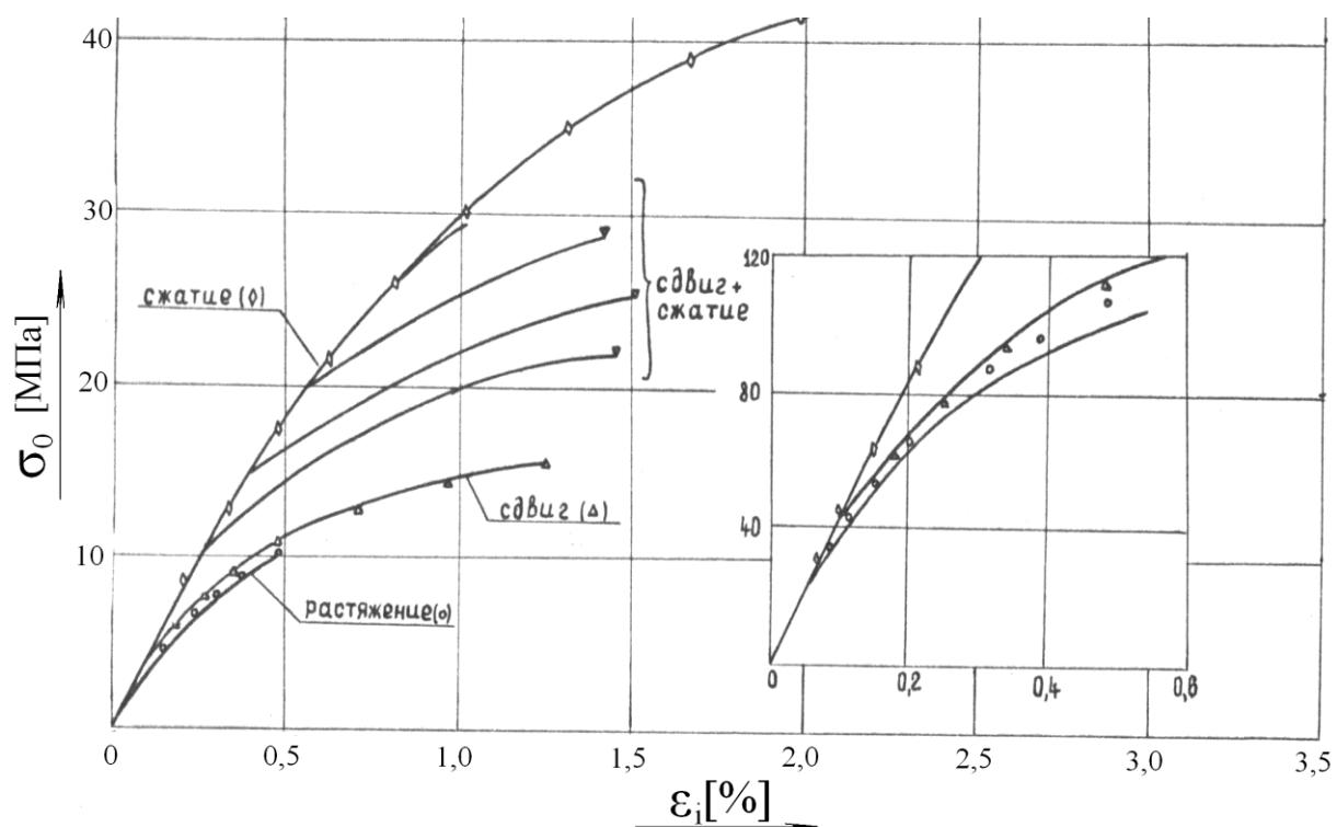
**Рис.16** Кривые деформирования в осях интенсивостей
