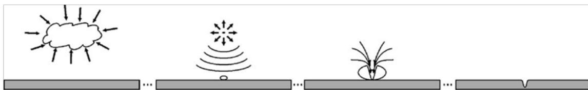
Рис. 2. Механизм кавитационного разрушения детали под воздействием микрогидроструи
