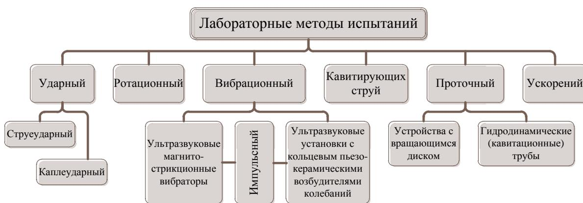
Рис. 3. Методы испытаний на кавитационную стойкость деталей
