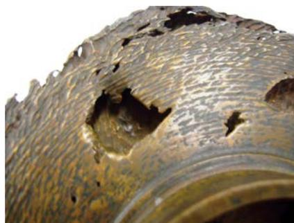
Рис. 1. Кавитационный износ рабочего колеса насоса
