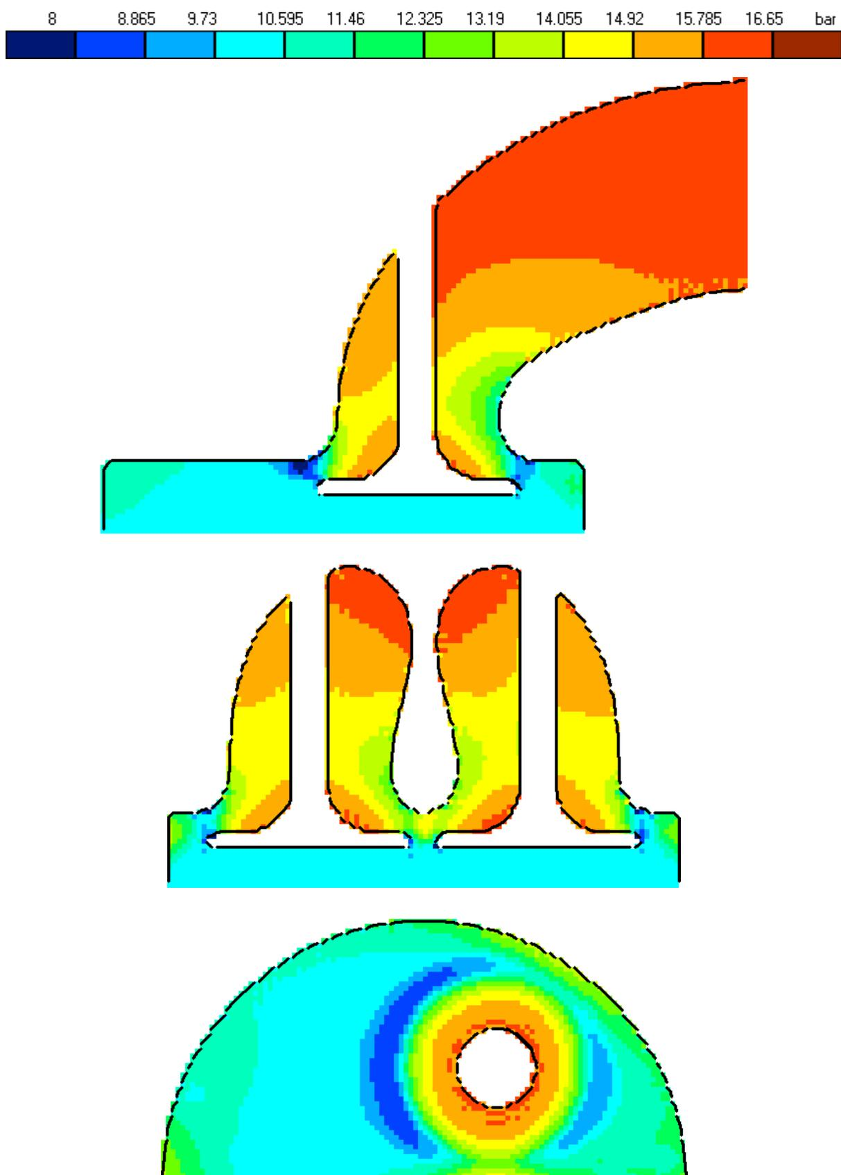
Рисунок А.1 – Поле статического давления в трех сечениях спрофилированного впускного канала
