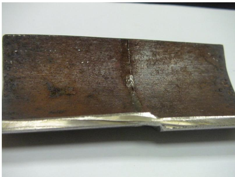
Рис. 5. Последствия разрыва прихваток и деформации кромок от теплового воздействия дуги
