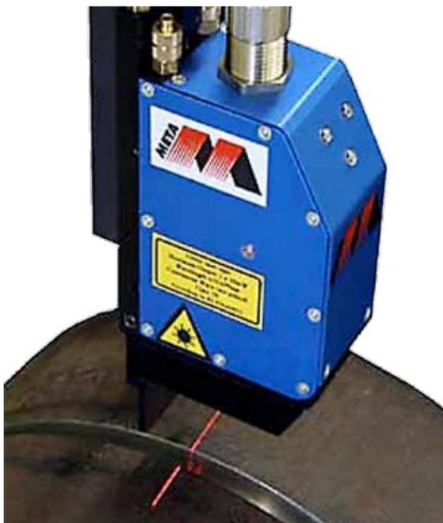
Рис. 8. Лазерный датчик Smart Laser Sensor, установленный над поверхностью кольцевого стыка свариваемых труб
