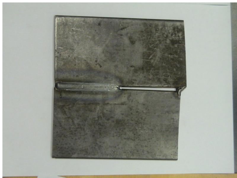
Рис. 2. Внешний вид обратного валика стыка, сваренного по базовой технологии
