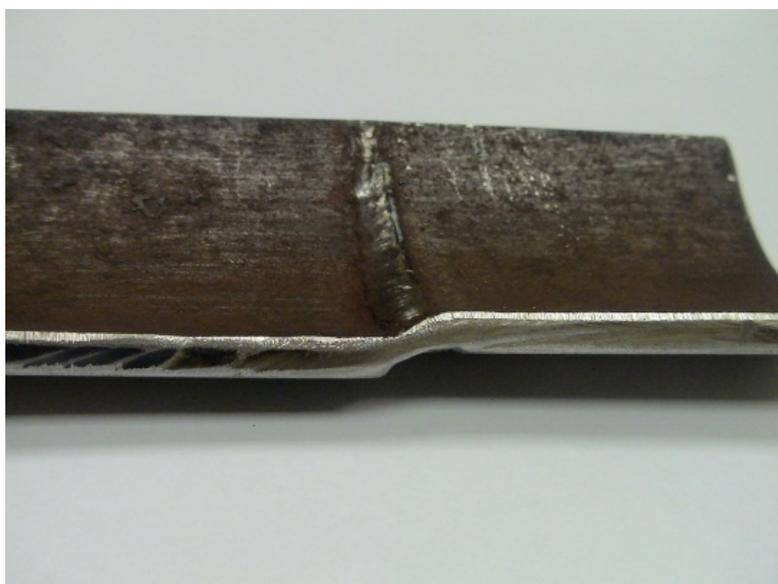
Рис. 3. Совместное влияние на формирование корня шва зазора в стыке и перекося кромок
