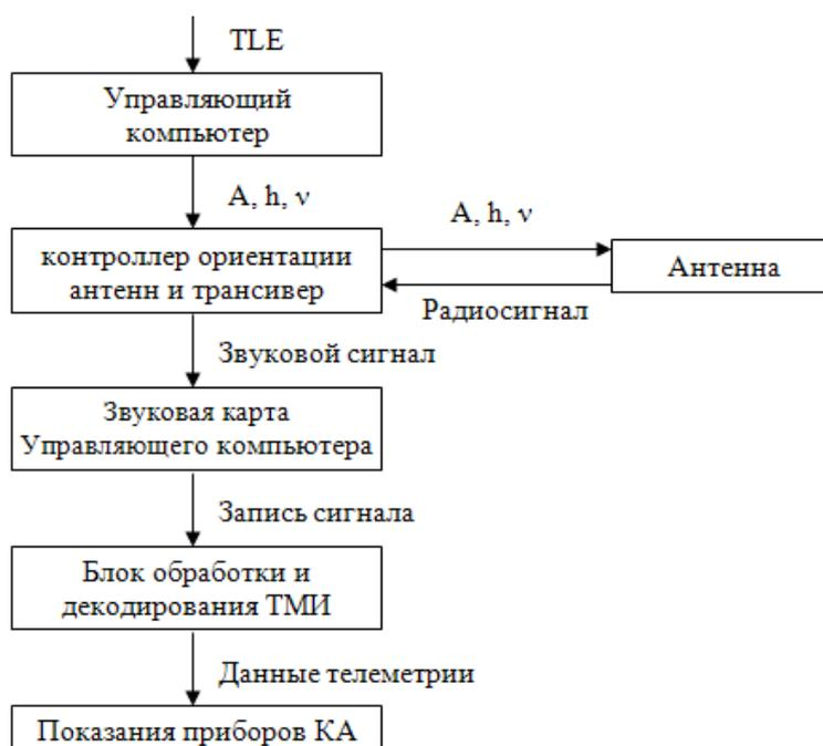
Рис. 3. Принципиальная структурная схема приема и обработки ТМИ в ЦУП-Б
