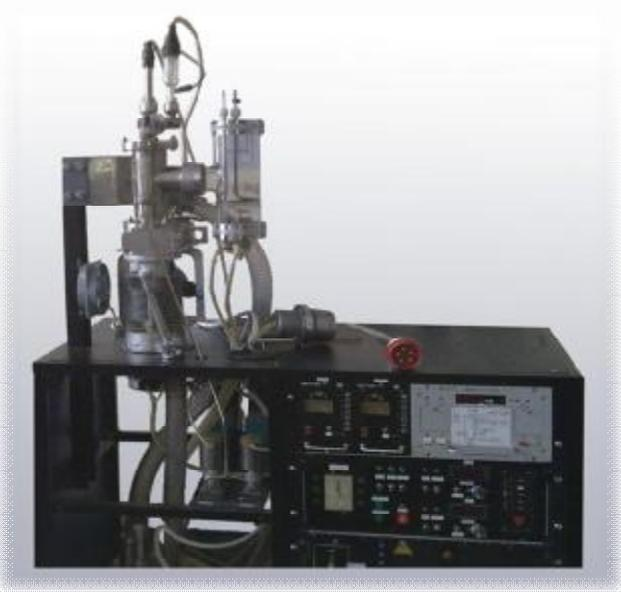
Рис.2. Малогабаритная вакуумная установка модульного типа
