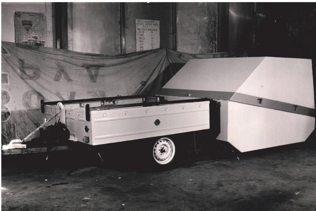
Рис. 1. Передвижная акустическая камера
