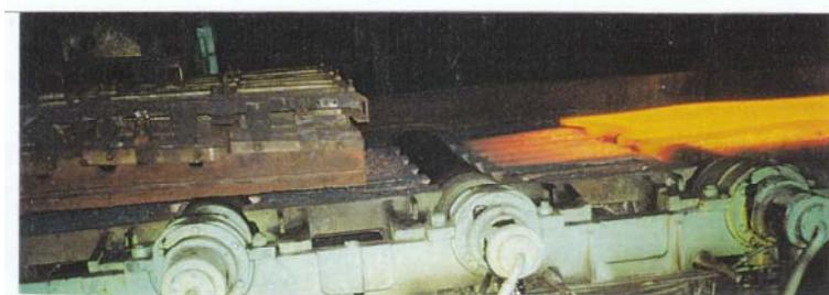
Рис. 6. Фотография заднего конца подката, покинувшего со скоростью  $< 1$  м/с последнюю секцию ТСУ с кассетами ТАЭ; расстояние между осями роликов 1200 мм.
