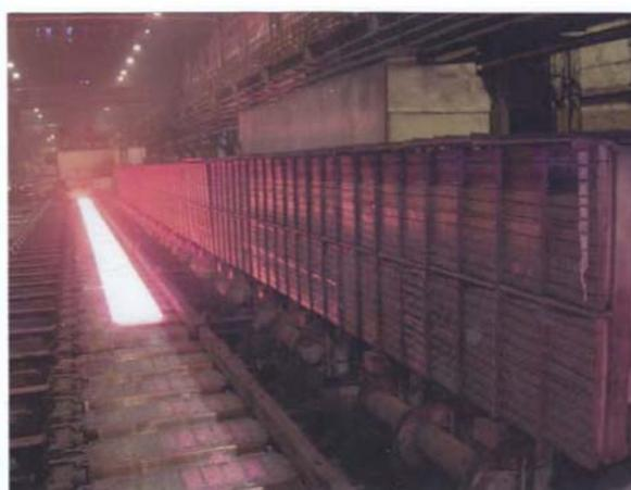
Рис. 3. Поперечный разрез (а; схема) и фотография внешнего вида (б) ТСУ на промежуточном рольганге ШПС г.п. 2000. 1 – специальная труба из жаростойкого сплава; 2 – верхний уровень ролика рольганга; 3 - межроликовая плита; 4 - воздушная окалина; 5 мулитокремнеземистая вата (теплоизолятор); 6 – подкат; 7 – войлок мулитокремнеземистой ваты.
