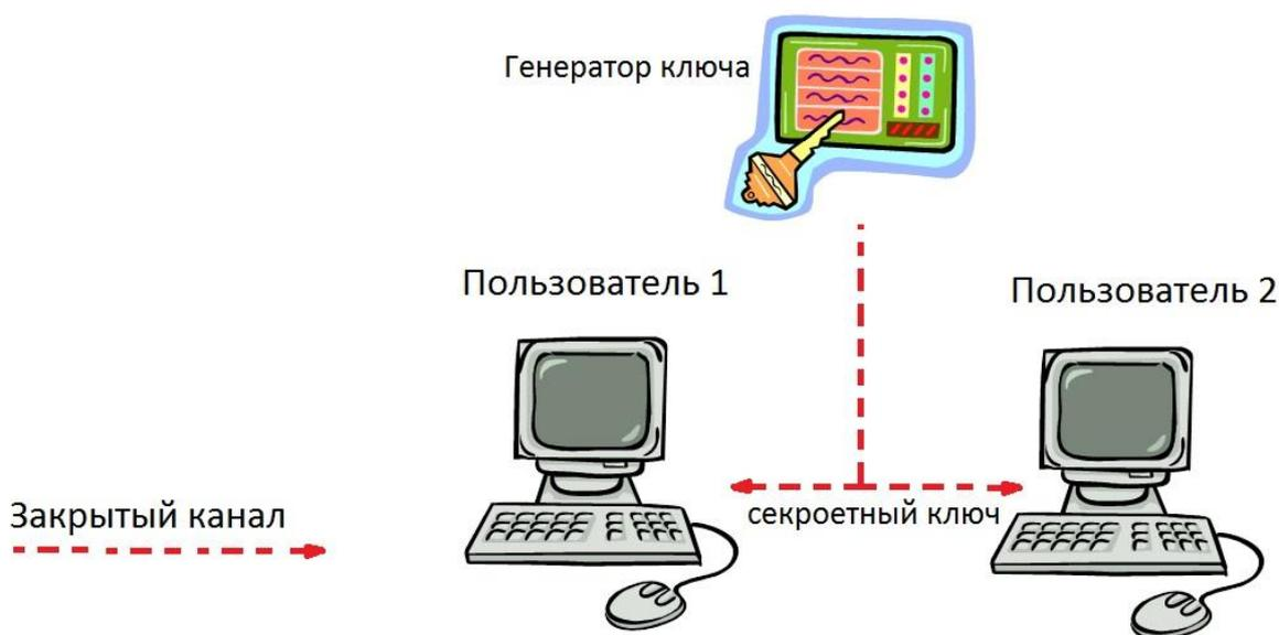
Рисунок 1. Схема распределения ключей при симметричном шифровании
